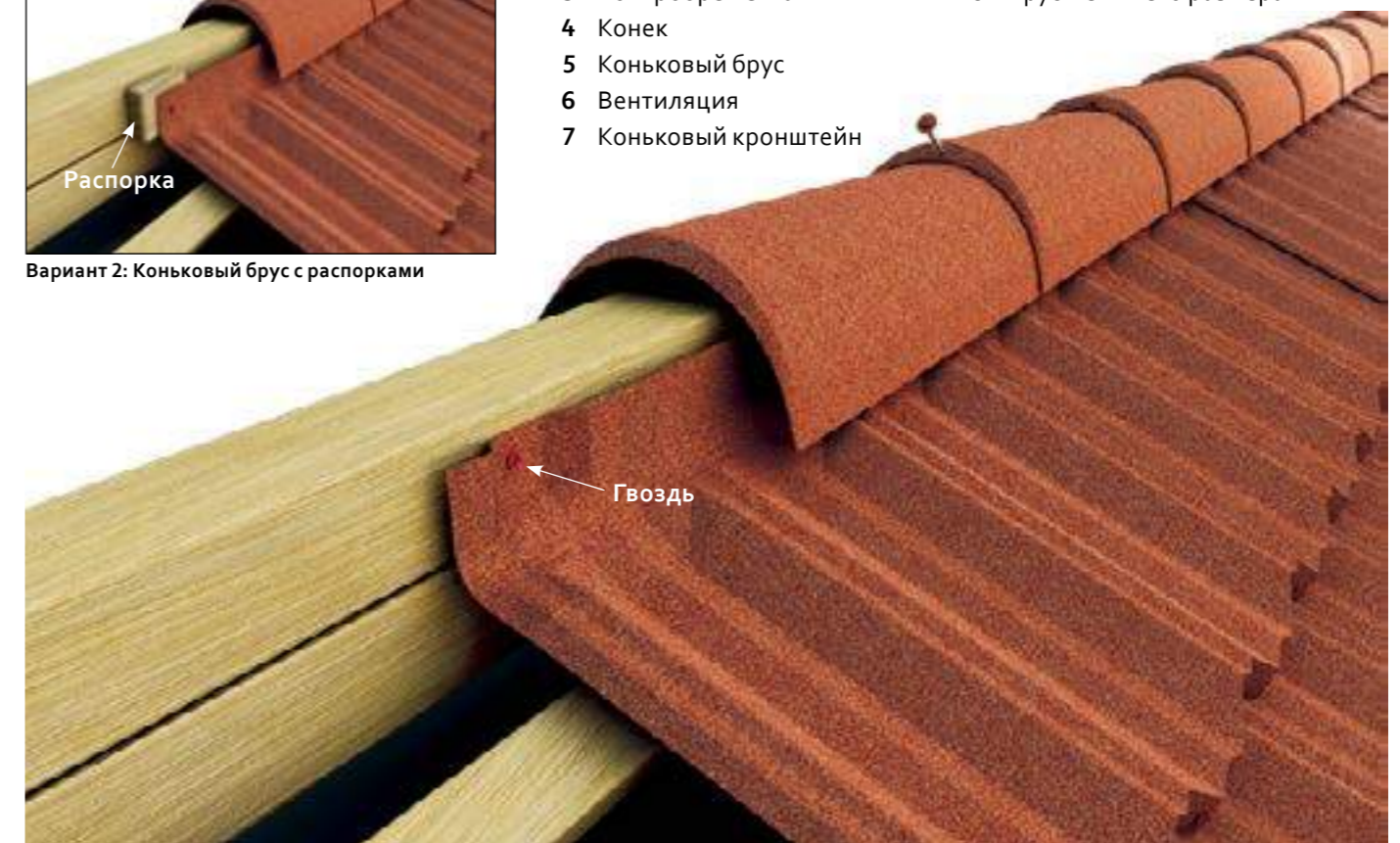
Вариант 1: Коньковый брус с вентиляционным отверстием
