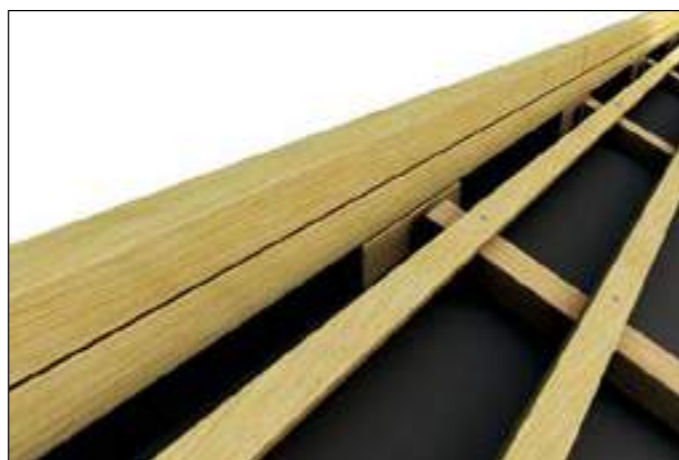
Вариант 2: Коньковый брус — монтаж с планкой обрешетки.
