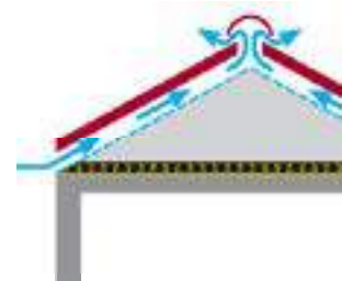
ХОЛОДНАЯ КРЫША С большим пространством над горизонтальной изоляцией.
