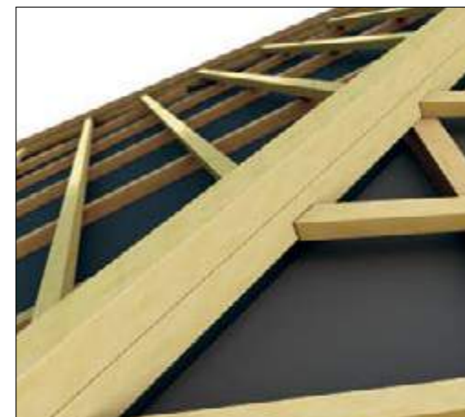
Вариант 2: Вальмовый брус — монтаж с планкой обрешетки
